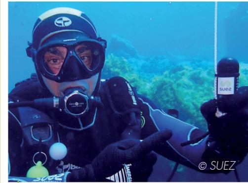
L'hydrophone a été placée dans la calanque de Cortiou, à Marseille
