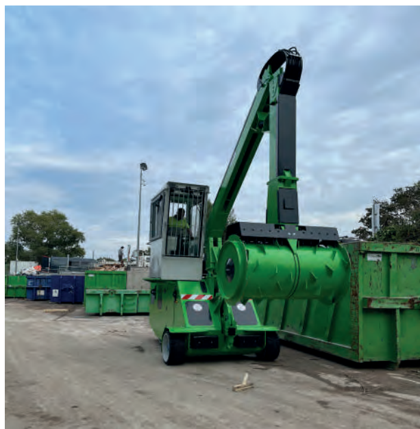
Le compacteur électrique disponible sur la déchetterie d'Aix-la-Parade
